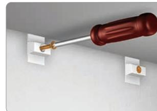
Montieren Sie die Clips an der Wand (alle 40 cm)
